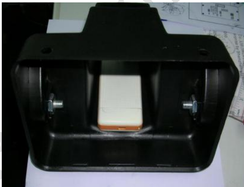
Motor reflektor házában elhelyezve
